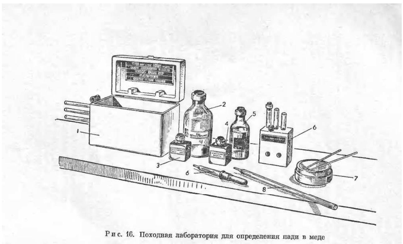
Рис. 16. Походная лаборатория для определения пади в меди
