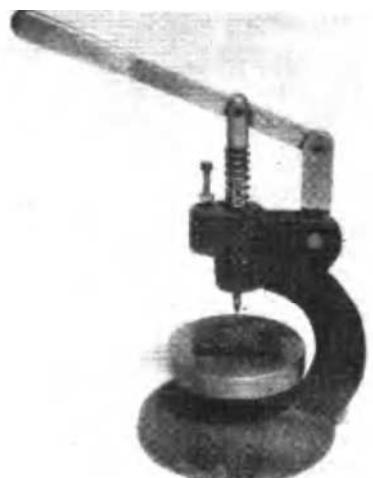
Рис. 24. Станок для изготовления меток
