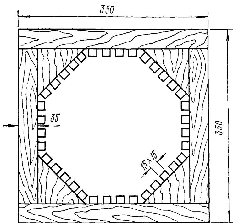
Рис. 24. Поперечный разрез округленной ступы воскопресса
