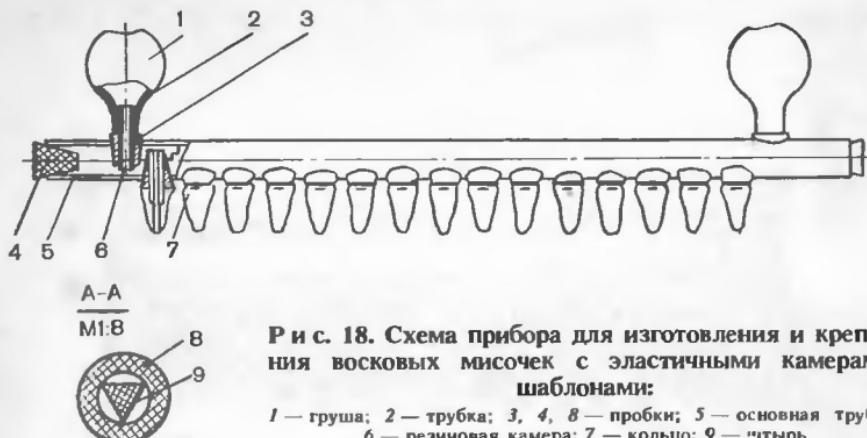
Рис. 18. Схема прибора для изготовления и крепления восковых мисочек с эластичными камерами-шаблонами:
