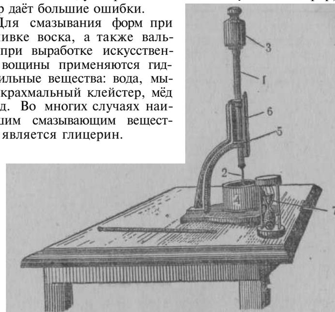
Рис. 191. Определение коэффициента твёрдости воска:
