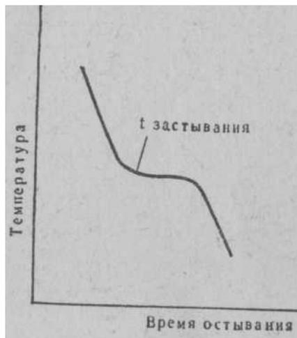
Рис. 188. Кривая падения температуры воска при его застывании.
